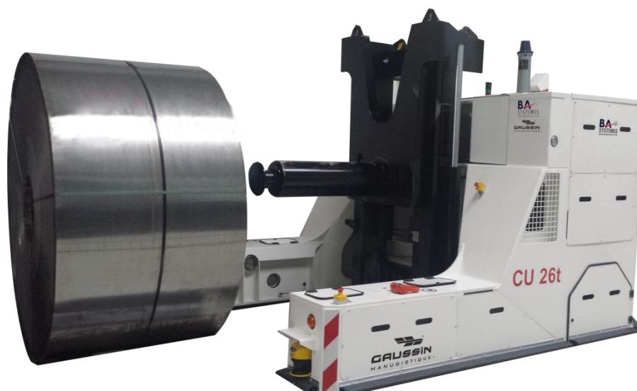
L'ACT® Automated Coils Transporter, GAUSSIN / BA SYSTEM, avec une bobine d'acier de 26 tonnes
