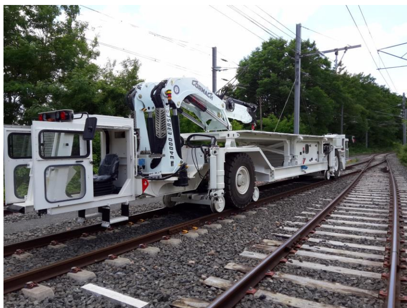
Véhicule Multi-Services rail-route fabriqué par la société METALLIANCE
