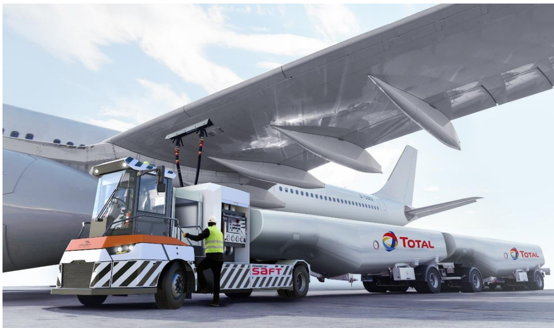
Véhicule avitailleur électrique ART FULL ELEC® équipé de deux citernes de 30 tonnes (illustration d'artiste – crédits : Gaussin)
