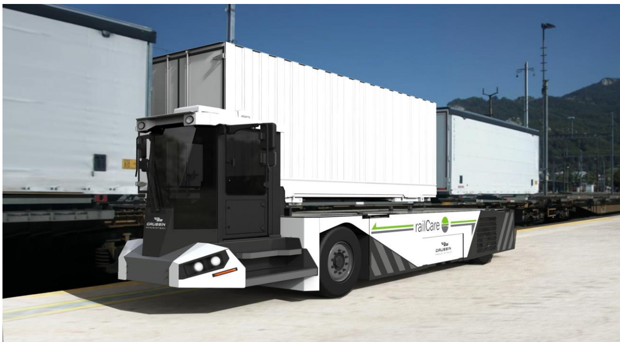
Transfert latéral de container depuis le train sur le véhicule ASBM® FULL ELEC
