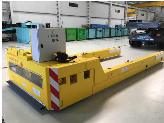
Automoteur Electrique CC Type 101 H, 6 tonnes, pour la société ISP
